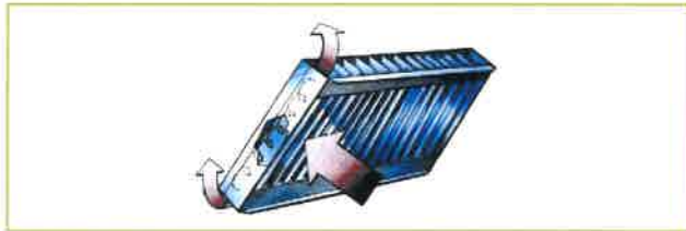
Figure 11 - Filtre à effet cyclonique
